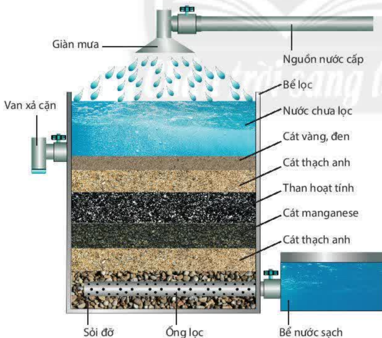
▲ Hình 16.1. Hệ thống lọc nước giếng bị nhiễm phèn
